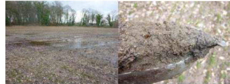
Figure 30 : culture humide et sondage pédologique permettant de mettre en évidence les traces d'hydromorphie dans ce type de parcelle (le Lannic)
