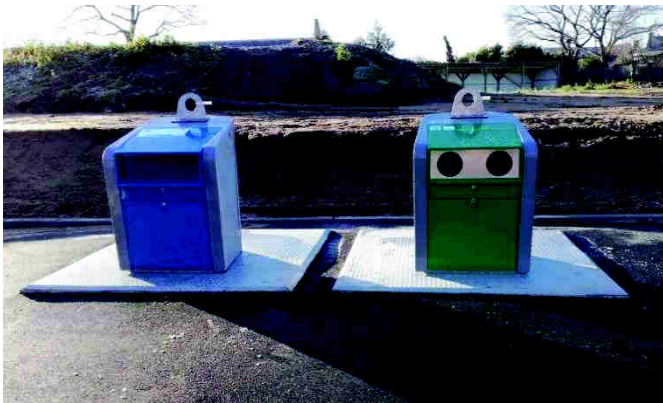
Colonnes enterrées, Camors
